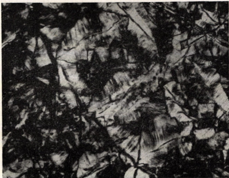
Obr. 1. Pokročilé štádium kryštalizácie amorfneho serpentínu z jadier. Individualizácia veľmi výrazná. Porovnaj napr. s tab. II., obr. 1. Bórka. Výbrus, nikoly X; zväčš. 180×.
