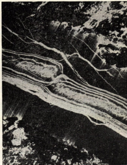
Obr. 3. Bastitizácia pyroxénu. Bastitové vlákna sa homoaxne striedajú s nepremennými reliktnými bronzitmi. Držkovce. Výbrus, nikoly X; zväčš. 38×.
