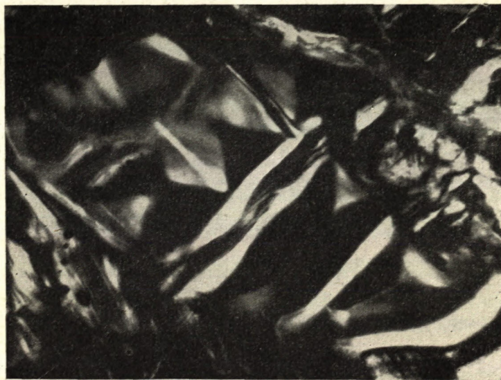
Obr. 2. „Presýpatkové“ štruktúry vzniknuté mnohonásobným zrastom vláknitých mikrolitov antigoritu pri kryštalizácii amorfných jadier. Bretka. Výbrus, nikoly X; zväčš. 420×.
