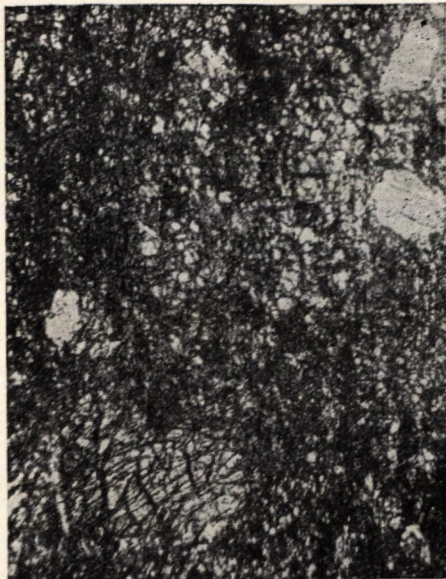
Obr. 1. Dunit. Väčšie kryštáliky monoklinických pyroxénov obklopených olivínom rozpadnutým počiatočnou serpentinizáciou na množstvo drobných zaoblených zrn. Vznikajúca slučková štruktúra. Jasov. Výbrus, nikoly X; zväčš. 14×.
